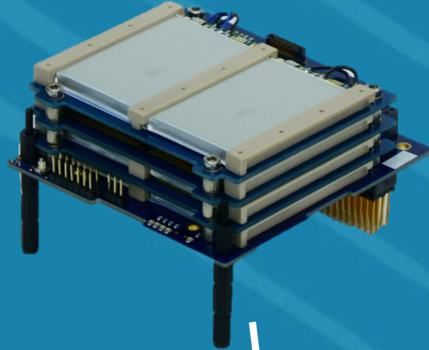
DHV Battery Module
