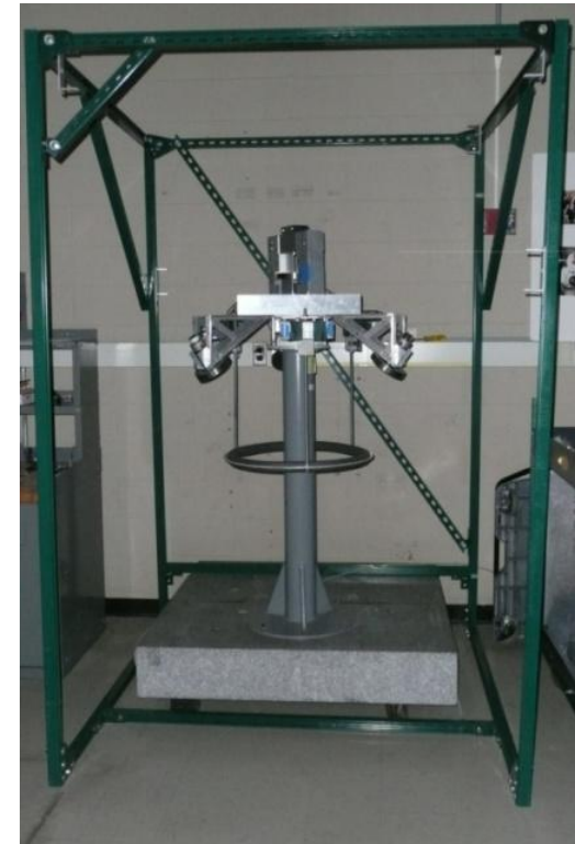
MIT 3DOF spherical air bearing test stand
