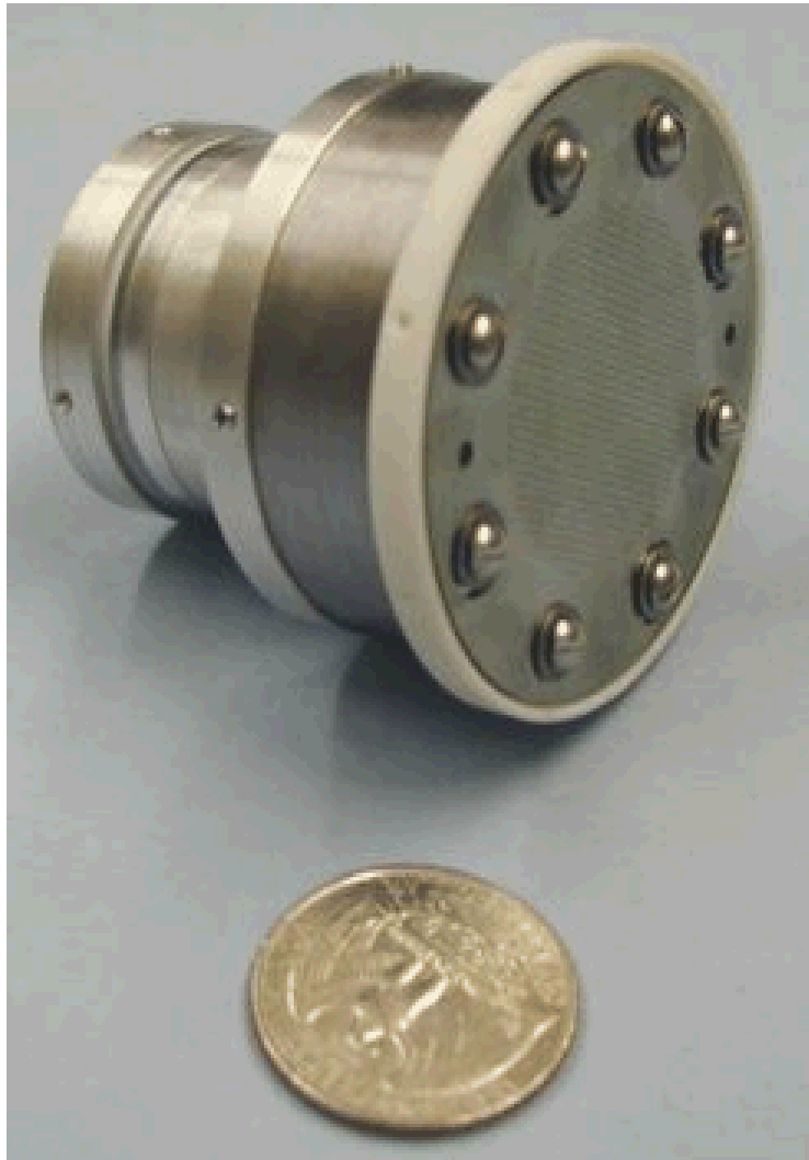
JPL Miniature Xenon Ion (MiXI) Thruster
